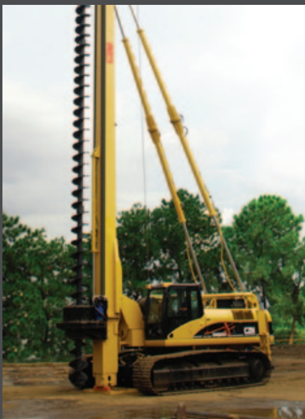
Montada sobre escavadeira - Excavator mounted
